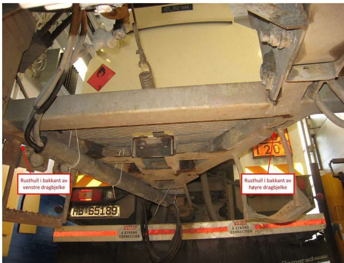
Figur 5.13: Rustskader i tilhengerdrag påvist i kontroll hos Statens vegvesen i mai 2011. Foto: Statens vegvesen
